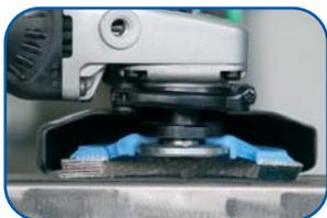
Per l'effetto stroboscopico, quando il disco EOLO ruota, si vede dove sta lavorando.
